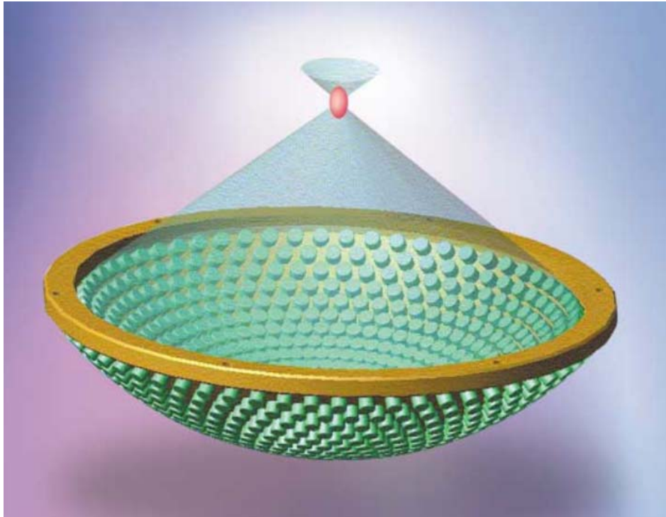
Schema der piezelektrischen Stoßwellenerzeugung
